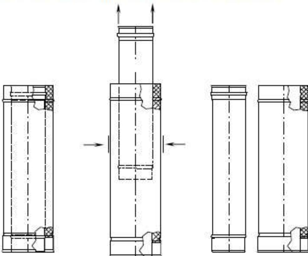
**П2.** Далее, с помощью ножовки или болгарки, укорачиваем на необходимое расстояние  $N$  внутреннюю трубу строго со стороны гладкой вставки, т. е. раструбное соединение должно остаться не тронутым. При этом нужно всегда помнить о следующем:
